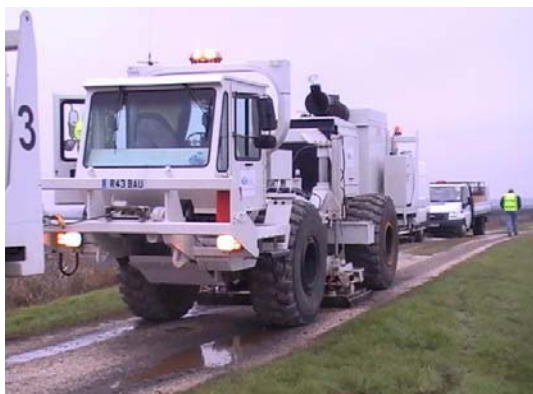
Esempio di Vibroseis, mezzi deputati all'energizzazione, lungo una strada
